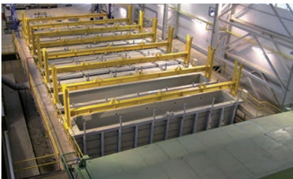
Galvanisation à chaud
