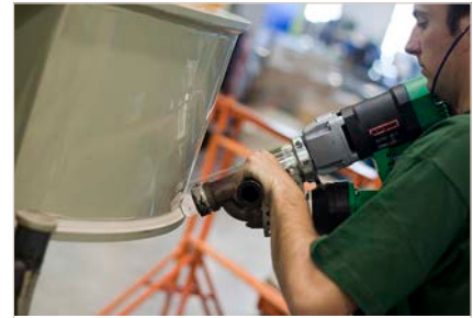
Soldadura en plástíco
